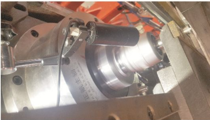
1. 长征运载火箭贮料箱专用搅拌摩擦焊接电主轴单元
